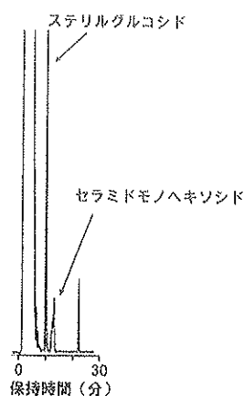
図4 光散乱検出-HPLCによるセラミドモノヘキソシドの検出
